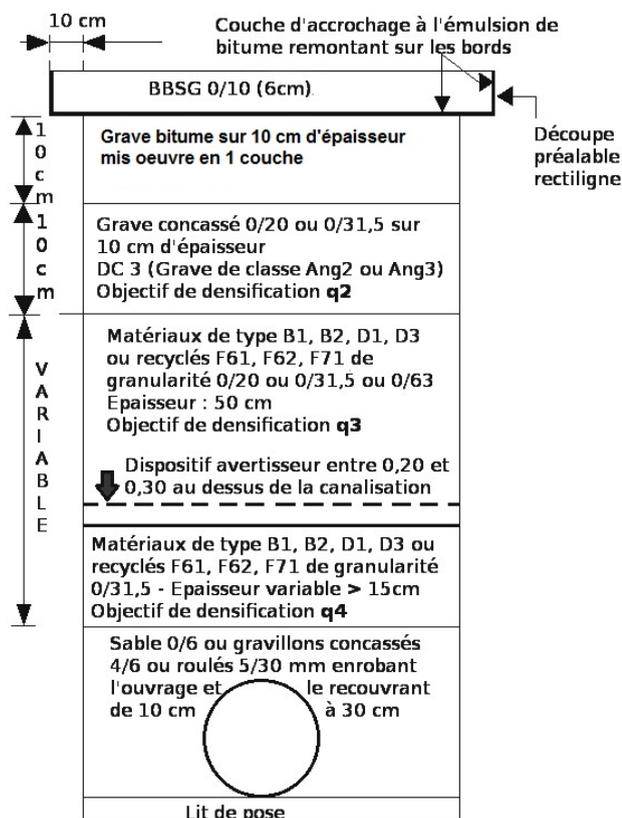
**Après la couche de roulement,** le traitement du joint sera assuré par la mise en œuvre d'un bitume pur avec sablage (sable porphyrique D < 4 mm).
